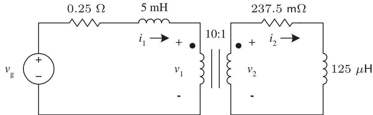
If  $v_g = 2500 \cos(400t)$  V, find  $i_1$ ,  $v_1$ ,  $i_2$ , and  $v_2$ .
